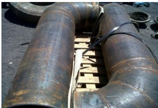
Ducto descarga overflow ciclones diám. 14"
